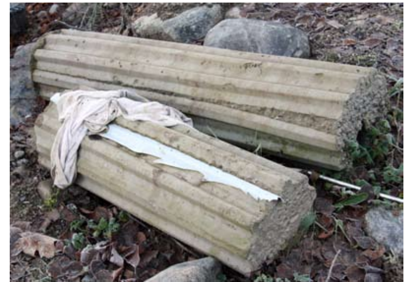
Provgjutning av de grekiska pelarna av betong.
